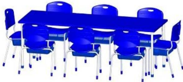
**Mesa Coletiva – 08 Lugares:** Tampos 03 unidades em ABS, sem textura, dimensões: 800mm x 800mm Espessura: 5mm, abas laterais de 20mm em todo o perímetro. Estrutura metálica: Pés: tubo redondo Ø51mm (2"), chapa 16, travessas longitudinal e transversal: tubo 20x30mm, chapa 16, suportes estruturais: chapas de aço dobradas, pintura: epóxi eletrostática, ponteiras externas em polipropileno de 60mm.
